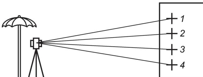
Рисунок 2 — Конфигурация для измерения вертикальных углов
