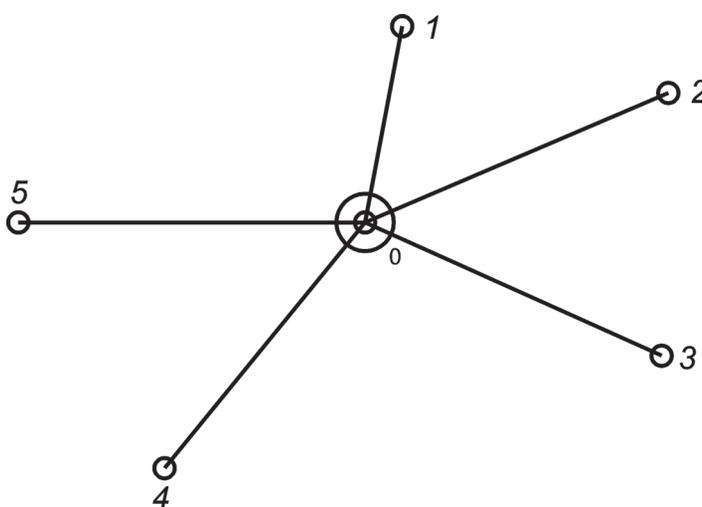
Рисунок 1 — Конфигурация для измерения горизонтальных углов
